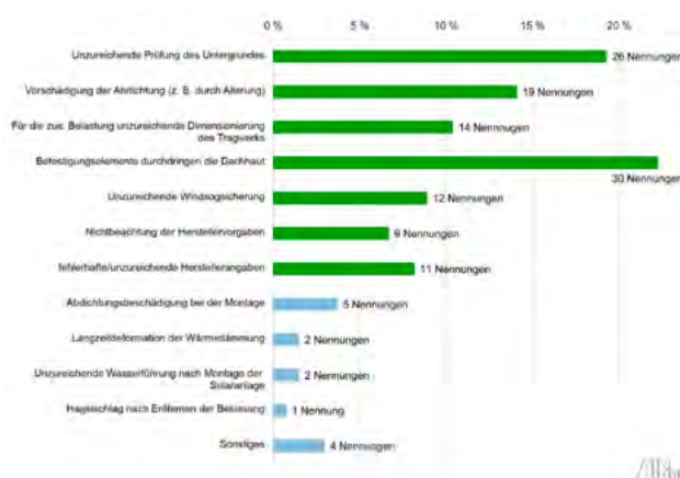
Abb. 2: Schadensursachen. Aus: Forschungsschrift „Solaranlagen auf Flachdächern im Gebäudebestand“ des Aachener Instituts für Bauschadensforschung und angewandte Bauphysik (AIBau), 2016
