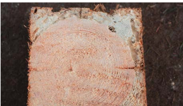
Abb. 7: Sparrenquerschnitt (Kiefer) mit relativ hohem Kernholzanteil und geringen Hausbockschäden
