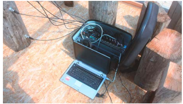
Abb. 6: Messapparatur zur Detektion von Hausbockfraßgeräuschen
