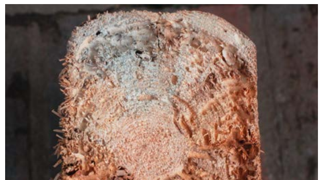
Abb. 8: Holzquerschnitt (Kiefer) mit sehr kleinem Kernholzanteil und massiver Hausbockschädigung im Splint
